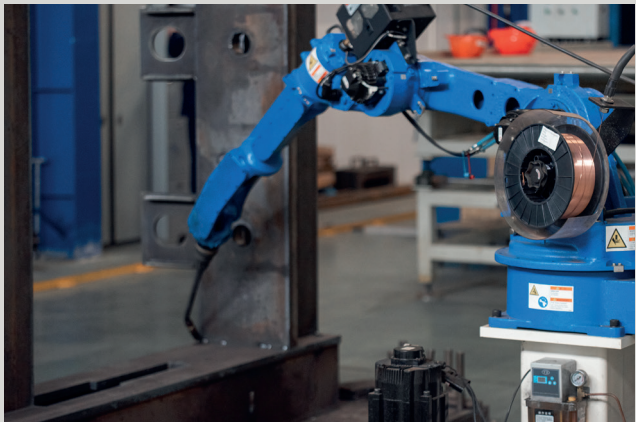
Станина собирается по системе «шип-паз» и сваривается в кондукторах на роботизированном комплексе
